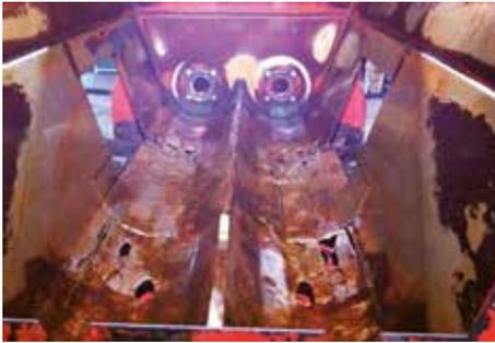
Hier wurde solange Verschleißblech eingeschweißt, bis nichts mehr ging
