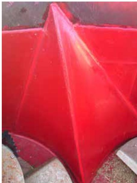
Das fertig belegte Eck mit PUCEST-Auskleidung
