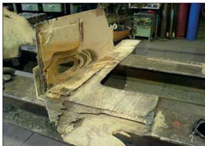
Mehrfach aufgeschweißte Bleche als Verschleißschutz
