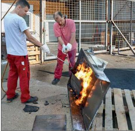
Aufwendiges Entfernen von Gummi-Schichten
