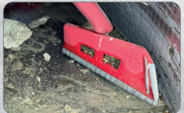
Überprüfung der Schaufel am 06.11.2023 nach einem Durchsatz von 15.749 m 3
