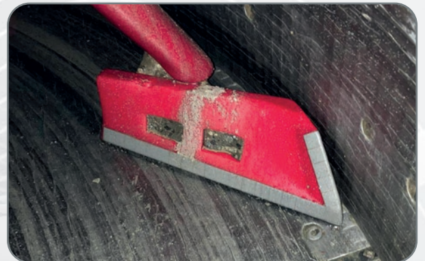
Überprüfung der Schaufel am 29.06.2023, nach einem Durchsatz von 4958 m 3
