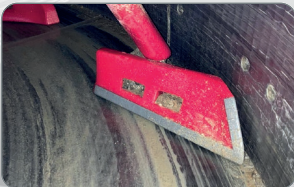
Überprüfung der Schaufel am 21.09.2023 nach einem Durchsatz von 11.864 m 3
