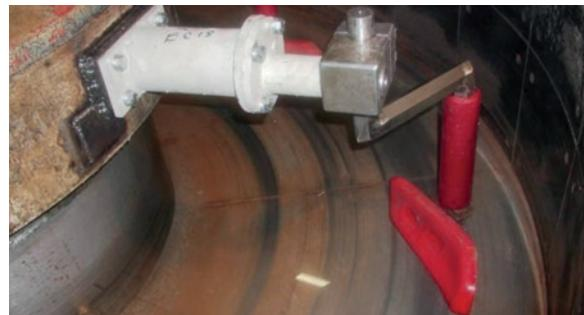
leiste montieren. Für keines der Teile werden mehr als 15 Minuten benötigt um diese auszutauschen. Ein leichtes Einstellen der Mischarm und Schaufel erlaubt dem Anlagenführer dieses auch zwischendurch zu erledigen.
