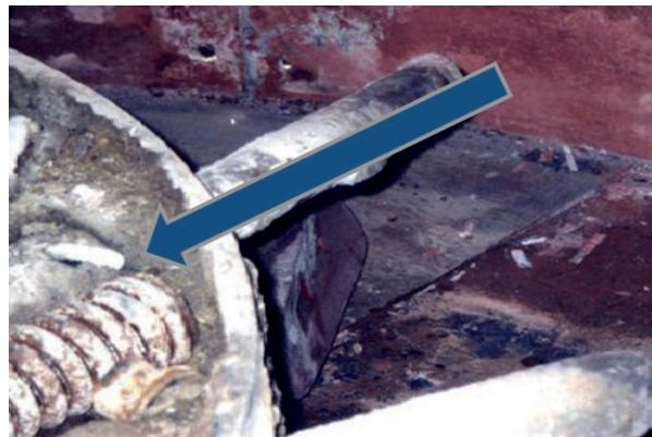
Ringtrommischer, egal welchen Ursprungs sie sind, leiden nach längerer Betriebsdauer immer an den gleichen Krankheiten. Es beginnt mit ausgeschlagenen Armlagern, und endet mit einem zubetonierten Rotor.
