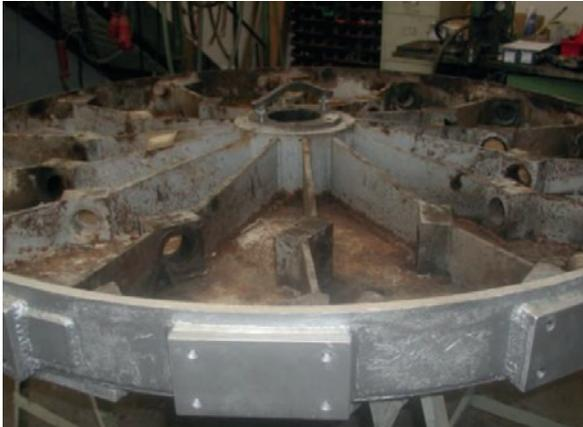
Die Mischarm, Federelemente, Stellhebel und die restlichen Teile werden aus dem Rotor entfernt. Die Armdurchführungen werden mit einer Platte verschlossen.
