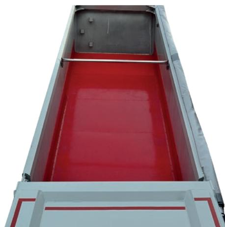
Die reparabile PUCEST Muldenauskleidung kann in jeder gewünschten Ausführung geliefert werden. Die Auskleidung besteht aus verschraubbaren Lochblechsegmenten, die gekantet und auch gewalzt werden können.
