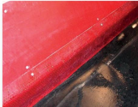
Sie ist eine Kombination aus PUCEST Platten mit und ohne Lochblech. Die Lochbleche dienen der Befestigung und der Stabilisierung, der reine PU-Teil hat durch seine Vorspannung leichten Kontakt mit dem Förderband und stellt sich automatisch nach, so dass kein Material mehr rechts und links herunterfällt. Der Verschleißschutz kann in beliebiger Höhe und Länge zusammengefügt und mit anderen PUCEST Platten kombiniert werden.
