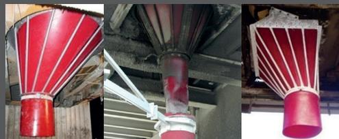
Auslauftrichter als geschlossene Einlage mit oder ohne Stabkorb.
