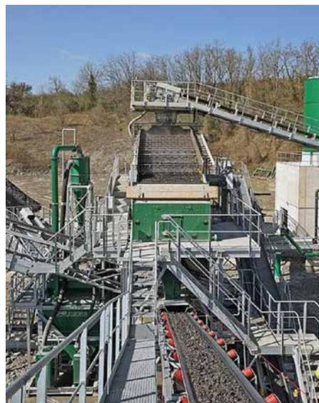
Direkt unterhalb des Doppeldeck-Waschsiebs ist die effiziente zweistufige Sand-Produktion mit Hydrozyklon platziert
